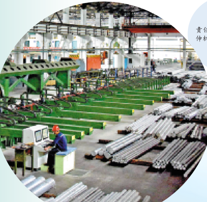
西北铝业有限责任公司1500T挤压机生产线。 张正平 摄
